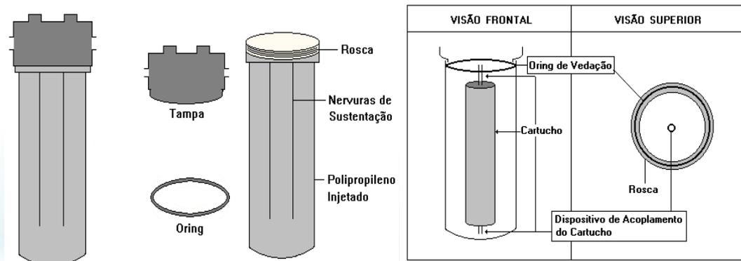
Internamente existem os acoplamentos especiais e seguros para os diversos tipos de cartuchos da nossa linha
