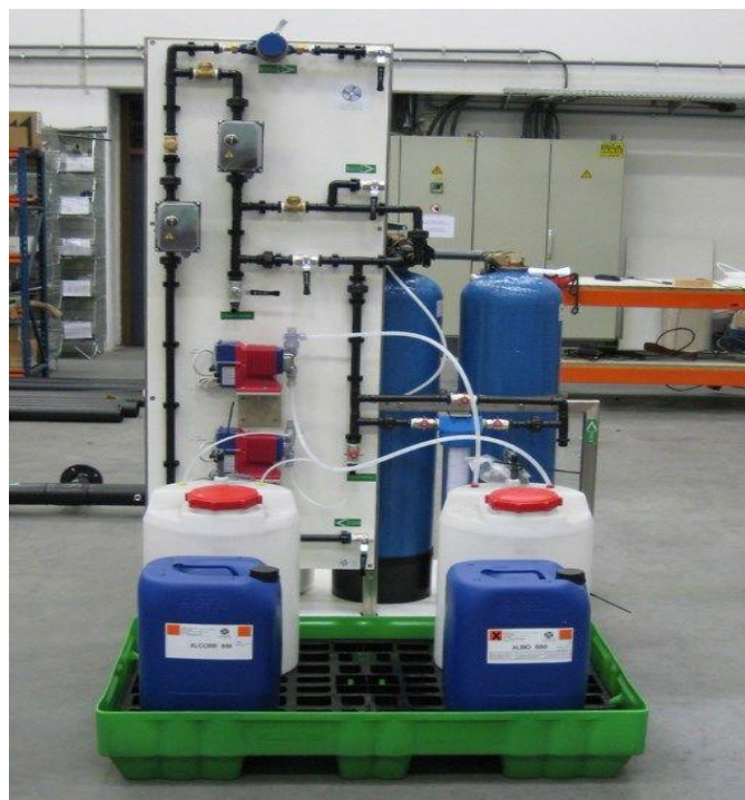
Unidade de Tratamento de Torres de Refrigeração e Chillers
